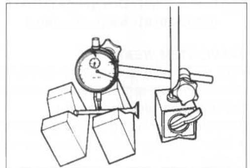
**VALVE HEAD RADIAL RUNOUT**
